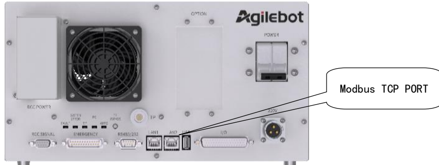
IRC-14A-C 系列控制柜 Modbus TCP 端口
